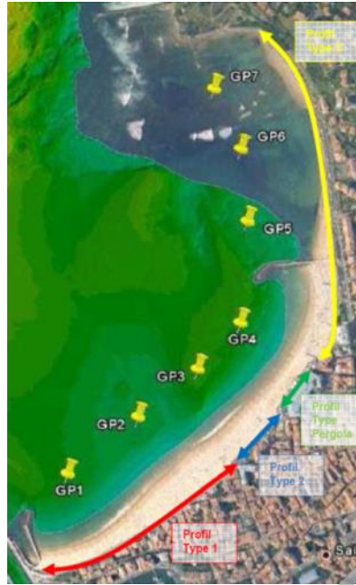
Figure 21 : Découpage des profils type du seuil de garantie de Saint-Jean-De-Luz selon l'étude de danger 2011.
